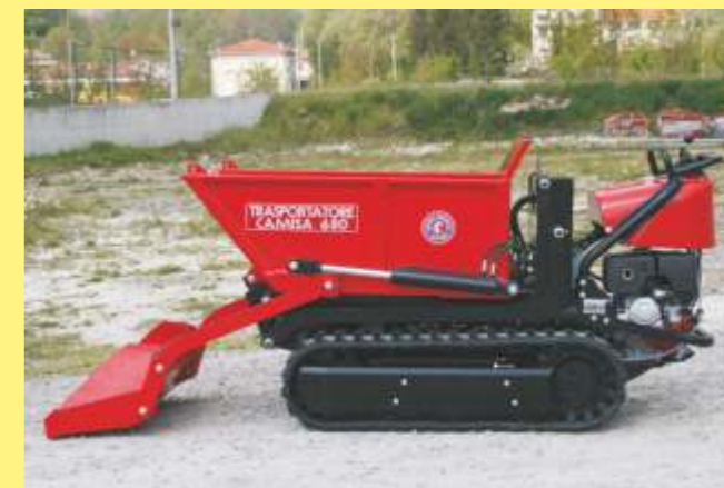
Pianale di carico dumper con pala autocaricante Dumper loading with selfloader Plateau dumper avec pelle autochargeuse Dumperpritsche mit ladeschaufel
