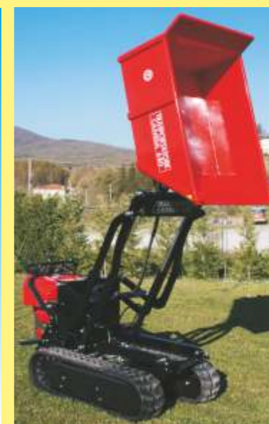
Pianale di carico dumper con elevatore, altezza di scarico mm. 1500-1700
