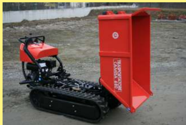
Pianale dumper con ribaltabile idraulico Dumper loading with hydraulic tipping Plateau dumper avec basculement hydraulique Dumperpritsche hydr. kippbar
