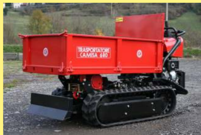
Verricello (Tiro diretto 1500 Kg) e lama di appoggio Winch (Direct Pull 1500 Kg) and bearing blade Treuil (Arrachement direct 1500 Kg.) avec barre d'appui Seilwinde (Zagkraft Trommel 1500 Kg.) und Festhaltenschild
