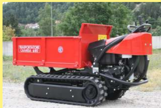
Motore diesel e pianale con sponde apribili Diesel engine and loading platform with opening sides Moteur diesel et plateau de chargement avec ridelles ouvrant Dieselmotor und Ladepritsche mit Abklappbaren Bordwänden
